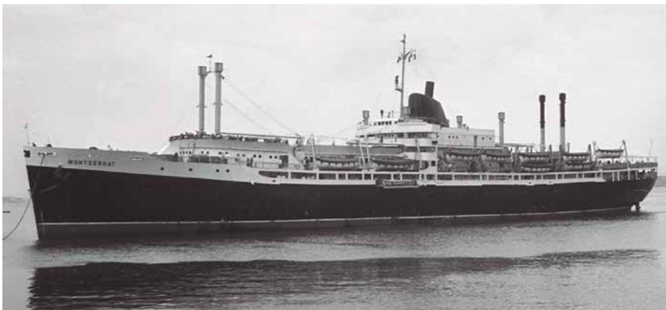
En la imagen, el “Montserrat” con el tubo que se le montó para intentar evitar el humo sobre la cubierta
